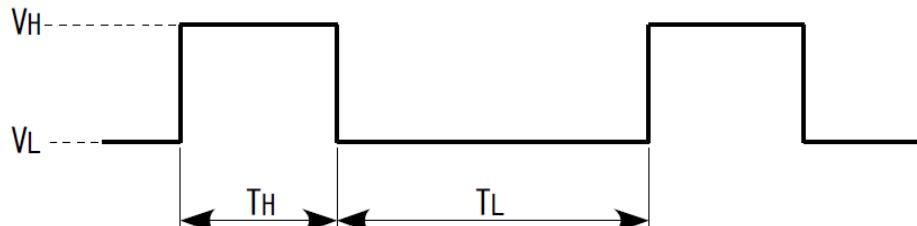
$$V_H : 4.0 \sim 6.0V \quad T_H : 0.5 \mu\text{sec. 以上} \\ V_L : 0 \sim 0.7V \quad T_L : 0.5 \mu\text{sec. 以上}$$
